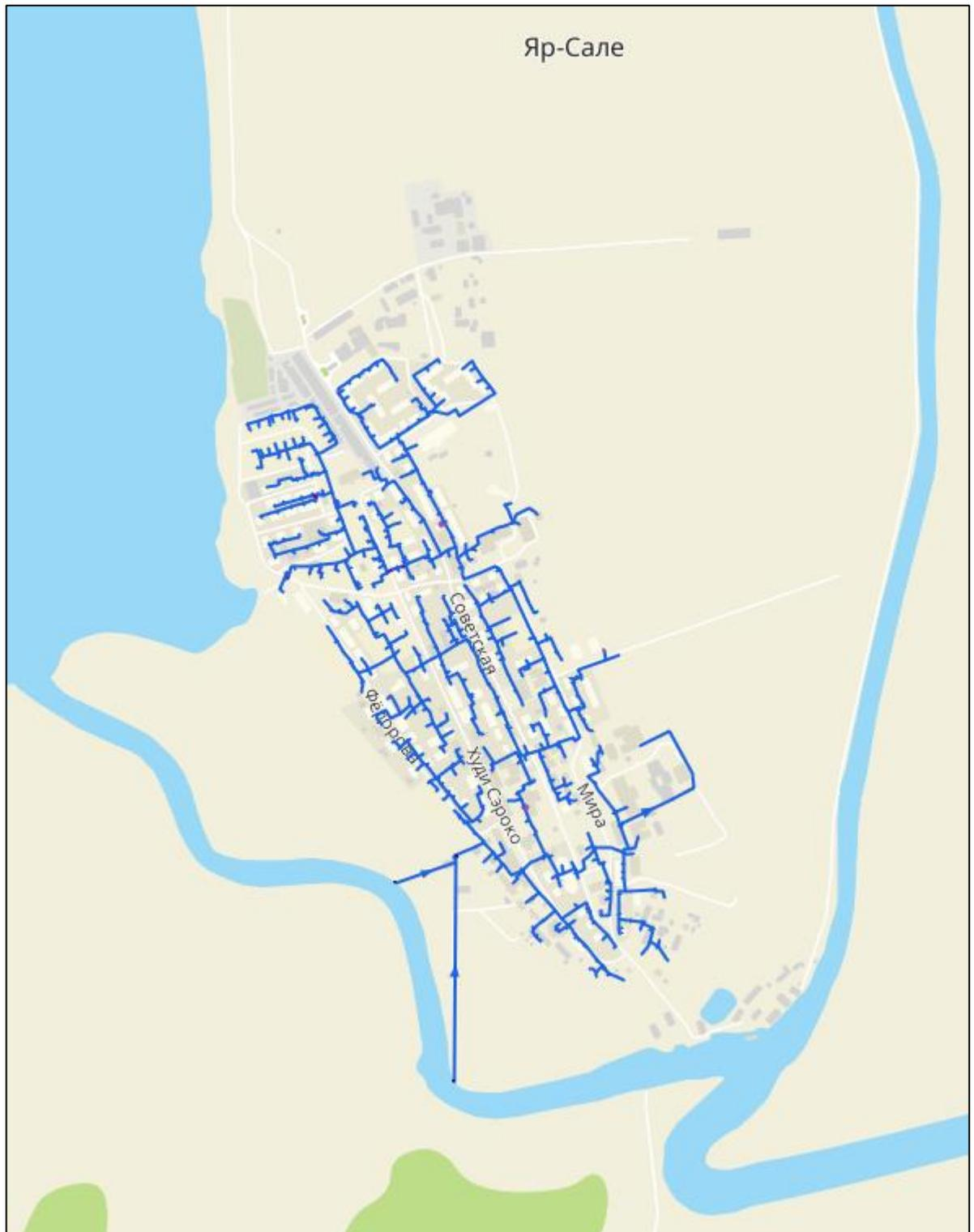
Рисунок 1.1.1. Схема зоны действия ЦС ХВС с. Яр-Сале
